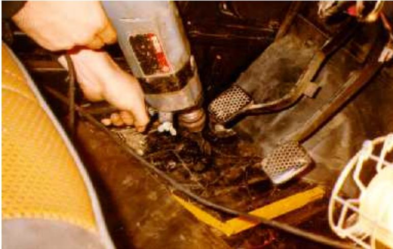
Weiteres befinden sich 4 Schrauben in der Mitte vor den Hinterrädern. Von allen 6 Schrauben die Muttern lösen. So jetzt müssen diese ebenfalls von oben aufgebohrt werden, damit die neuen Schrauben durchpassen. Die mittleren 2 der 4 sind leicht zu finden. (Bei den Gurten zwischen den Sitzen die kleine Erhebung). Die 2 äußeren der 4 sind in der leichten Abschrägung ganz am Rand (jeweils links und rechts.). In diese Abschrägung ganz am Rand mit der Trennscheibe ein Loch schneiden. (siehe Bild)
