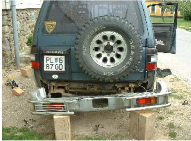
Im nächsten Schritt müssen die 12 Schrauben lokalisiert und aufgeschraubt werden. Vier befinden sich hinten, die sind vom Kofferraum zugänglich (jeweils zwei links und zwei rechts), vier befinden sich in der Mitte (jeweils zwei hinter den vorderen Sitzen und bei der hinteren Rückbank), zwei befinden sich links und rechts im Fußraum der Vordersitze und zwei sind vom Motorraum zugänglich. Die sind besonders schwer zu finden da dort ein Klebeband den Hohlraum schützt.
