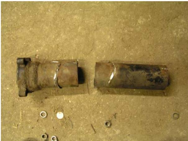
Als nächstes die beiden Enden mit 4 Schnitten einschneiden. Diese werden dann später wieder zugeschweißt und garantieren, dass sich das eingelegte Rohr ganzflächig mit dem Achsrohr verbindet.
