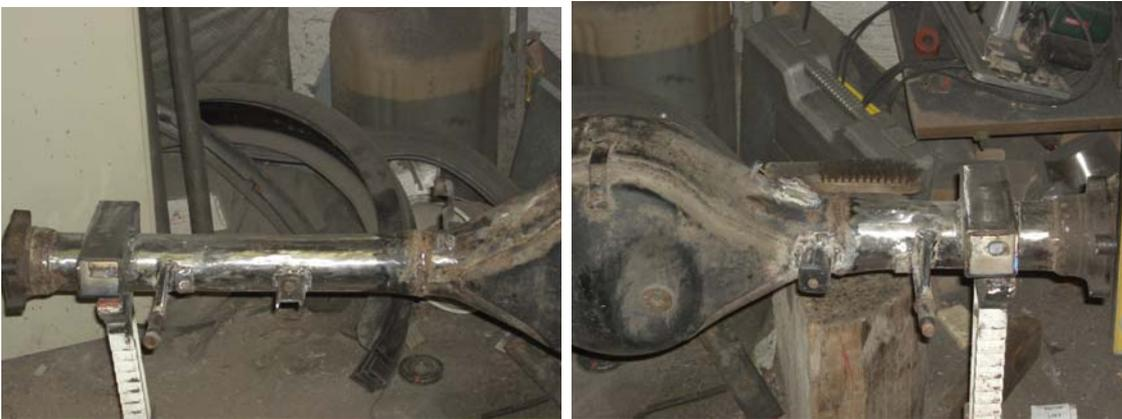
So fertig ist die Hybridachse, jetzt muss sie noch gereinigt werden (dazu habe ich einen Klobesen verwendet). Außerdem ist es zu empfehlen, neue Simmeringe zu verbauen weil die Alten sicher beim Umbau gelitten haben. Dann muss die Achse noch Grundiert und Lackiert werden.
