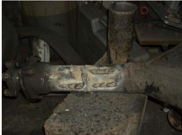
Anschließend wird das Ganze fein verschliffen sodass es wie ein Teil aussieht.
