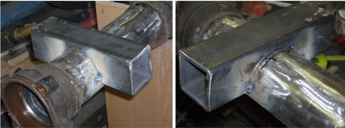
Ist das Springpad auf der ersten Seite fertig verschweißt kann der Winkel einfach für die zweite Seite übertragen werden indem die Fertige mit der Wasserwaage eingerichtet wird. So sehen die Springpads auf der Hybridachse aus.
