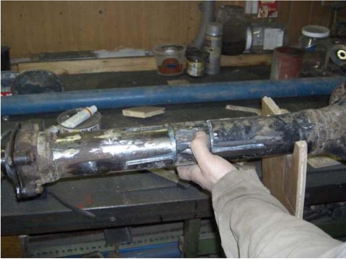
Genau wie auf der linken Seite wird das ganze mit Schraubzwingen gehalten und durch Schweißpunkte fixiert, und schließlich voll verschweißt
