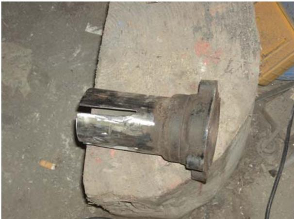
Als nächstes die Steckachse mit dem Radlager in das Ende einpressen und verschrauben.
