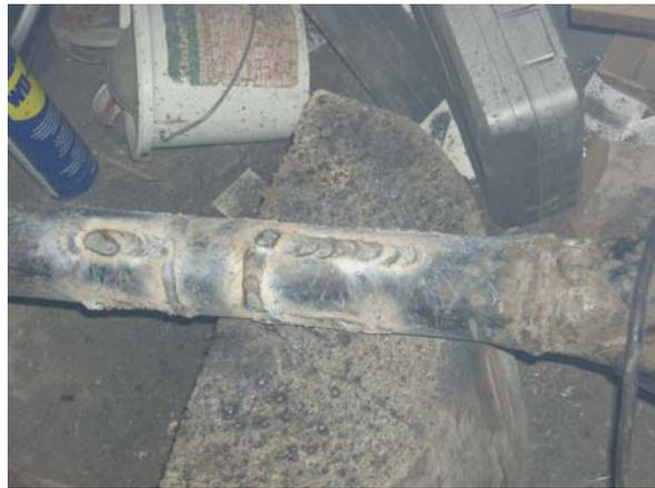
Danach muss noch alles geschliffen werden sodass es wie ein sauberes Achsrohr aussieht.
