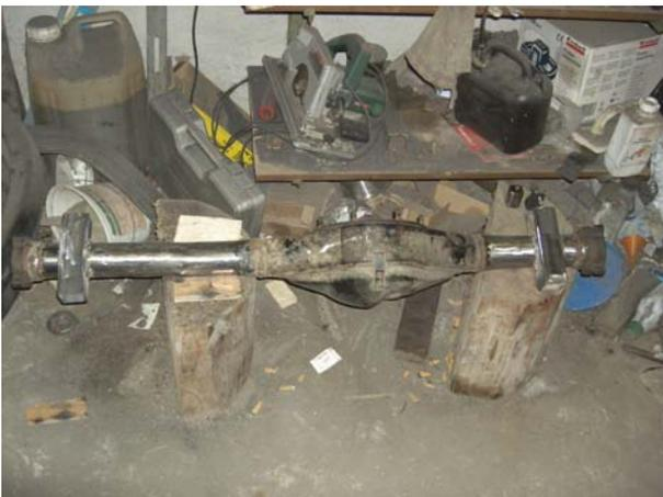
Als nächstes fehlen noch die Dämpferaufnahmen. Obwohl es möglich ist, die Originalaufnahmen weiter zu verwenden ist es nicht empfehlenswert für einen sauberen SPOA-Umbau. Daher ist es empfehlenswert die Dämpferaufnahmen auf die Achse zu schweißen. Dazu kann man die Originalaufnahmen von den Platten abtrennen und mit einem entsprechenden dicken Flacheisen modifizieren.
