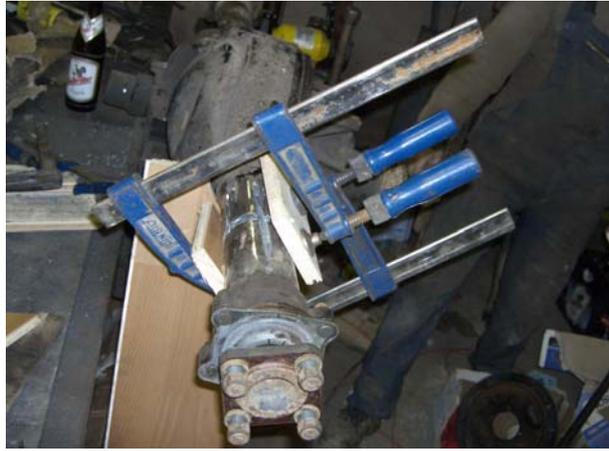
Zur Kontrolle mit einer Wasserwaage die Achse waagrecht einrichten und das mit den Schraubzwingen fixierte Ende nachmessen und gegebenenfalls korrigieren.
