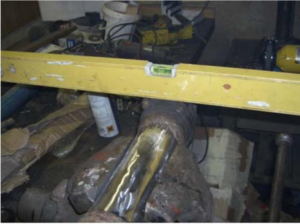
Danach folgt die rechte Seite, die um 7,5cm verlängert werden muss. Das Achsrohr auf der rechten Seite misst ca. 36cm von Schweißnaht zu Schweißnaht. Am besten schneidet man das Achsrohr in der Mitte also nach 18cm durch. **ACHTUNG:** immer mit Schutzbrille arbeiten! (nicht so wie auf dem Foto ;-)
