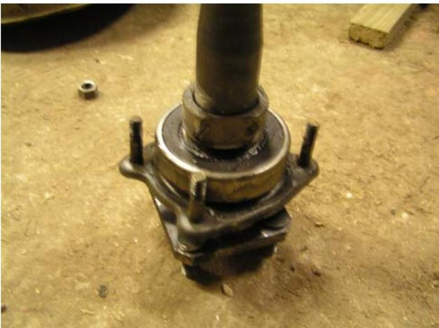
Als nächstes wird die Vitara Achse aufgeschnitten. Wir beginnen mit der linken Seite (der kleineren). Es müssen 20cm hinaus geschnitten werden. Das Achsrohr auf der linken Seite
