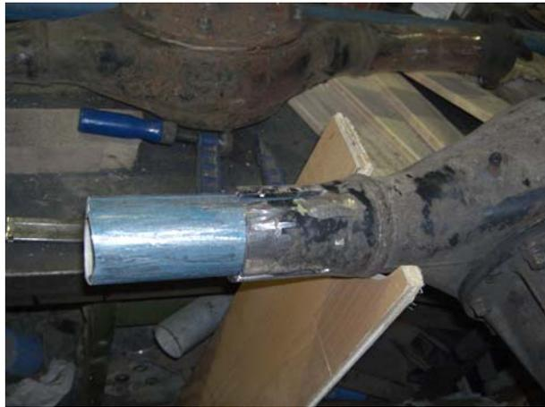
Das Ende mit der Steckachse drauf stecken sodass die Steckachse im Differential einrastet. Die beiden Teile mit 4 Schraubzwingen und 4 leisten fixieren sodass die Einschnitte frei bleiben.
