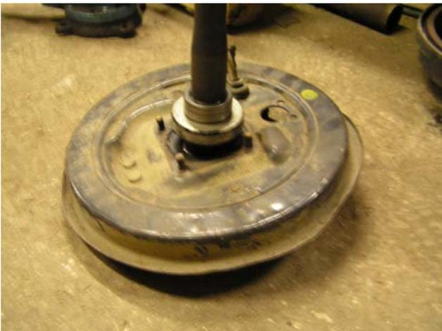
So sieht die Samurai Steckachse mit dem Vitara Radlager und dem Vitara Backingplate aus.
