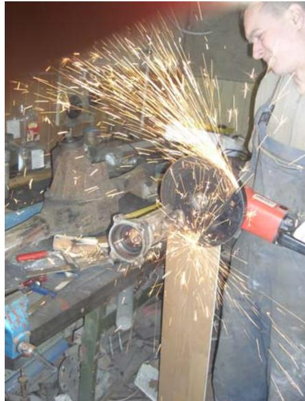
Und wie auf der linken Seite werden auch bei der rechten Seite 4 Einschnitte zum einschweißen gemacht. Zusätzlich empfiehlt sich aus dem aus der rechten Seite hinaus geschnittenen Teil 6cm hinaus zu schneiden und hier einzufügen. Wie auf der linken Seite wird die Steckachse mit dem Radlager in das Ende eingepresst und verschraubt. Auf dem Bild sieht man die fehlenden 7.5cm und das 40cm lange eingeschobene Rohr, sowie das 6cm Stück das in die Mitte eingeschoben wird.
