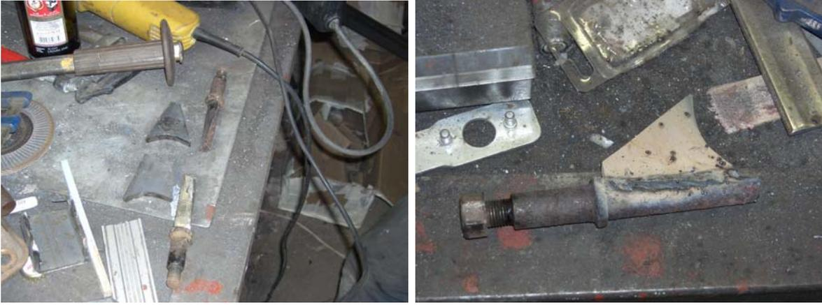
Am Ende müssen noch die Teile für die Bremsleitungen, für das Handbremsseil sowie die Dämpferaufnahmen angeschweißt werden.
