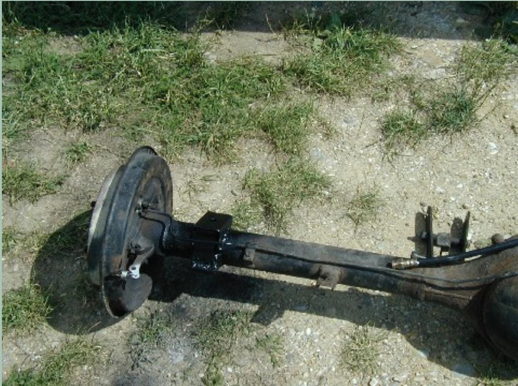
An der Vorderachse müssen noch die neuen Stossdämpferaufnahmen für unten angeschweißt werden , dadurch können längere Stoßdämpfer montiert werden , was den Komfort und den Verschränkungsindex verbessert . Als Befestigungspunkt erfüllen die originalen Springpads gut ihren Zweck – aufpassen, dass der Dämpfer dann nicht an der Feder ansteht !
