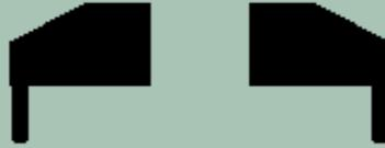
Die Adapter aus einem 10mm Flacheisen werden an die originalen Springpads geschweißt damit die neuen längeren Dämpfer montiert werden können.
