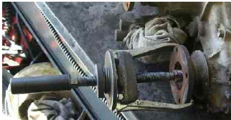
Danach können die Schrauben gelöst und die Gehäuseteile vorsichtig auseinander geschlagen werden. Wichtig ist, dass die Imbus-Mutter - die die Schaltgabel spannt - ebenfalls aufgemacht werden muss (Achtung auf den Ball).
