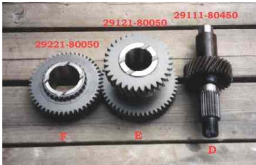
Für die Rocklobster Übersetzung braucht man ebenfalls 410er Zahnräder. Der Trick ist, Teile vom 410er Getriebe mit Teilen vom Samurairgetriebe zu kombinieren. Genauer gesagt werden 3 Zahnräder (vom Hi in orange) vom 410er genommen, während die beiden für den LOW aus dem Samurai/413er (in blau) Getriebe genommen werden.
