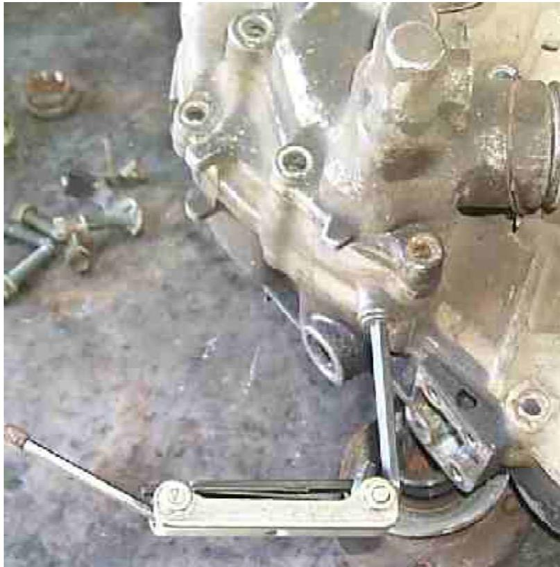
Sind die beiden Gehäuseteile offen, so liegen zwei der drei Wellen frei, während es für die dritte notwendig ist, das Tachoritzel (188, 189, 190) zu entfernen. Das liegt auf der Seite und kann einfach mit einer Zange rausgezogen werden.
